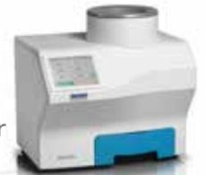
**Aquamatic 5200** Der zurzeit präziseste Getreidefeuchtigkeitsbestimmer. 10-Sekunden-Analyse von Feuchte, spezifischem Gewicht und Temperatur in Getreide und Ölsaaten.
