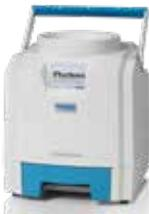
**Aquamatic 5800 Manual** Ein batteriebetriebenes, tragbares Feuchtemessgerät, das von der Genauigkeit, Wiederholbarkeit und Zuverlässigkeit des AM 5200-A profitiert.
