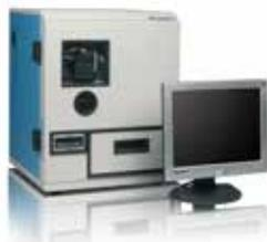
**SKCS 4100** Einzigartiges Gerät zur Härte-Klassifizierung und Bestimmung der Gleichförmigkeit einzelner Körner.
