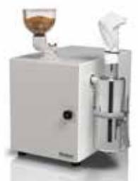
**Labormühlen** Hammer- und Zahnscheibenmühlen für die richtige Probenvermahlung. Werden bei der Fallzahl-, Glutomatic- und NIR-Methode eingesetzt.
