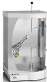
**BVM** Laser-basierte Volumen- und Dichtemessungen für Brot, Backwaren, Tiefkühlmilchprodukte, Süßigkeiten und viele mehr.
