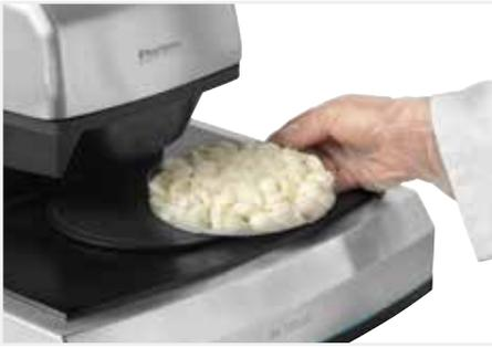
Die Probe in eine Einwegschale füllen
