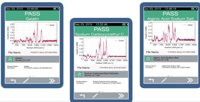
Hilfsstoffe die häufig mit den pharmazeutischen Produkten verarbeitet werden, zeigen keine Fluoreszenz bei einem Anregungslaser von 1064 nm und lassen sich deshalb schnell und zuverlässig mit Progeny™ identifizieren.
