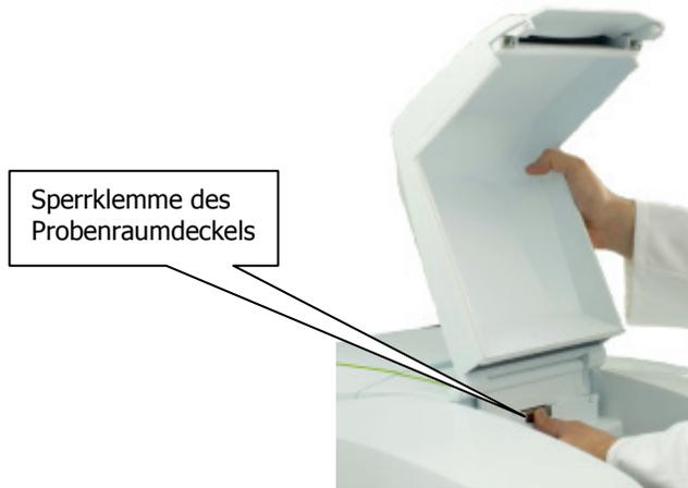
**Abb. 58. Entfernen des Probenraumdeckels**
