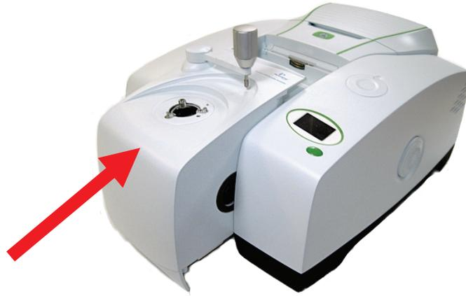
**Abb. 60. Installieren eines Messzubehörs im Probenraum**
