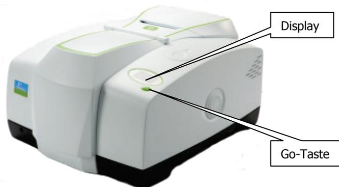
**Abb. 15. Display und Go-Taste auf der Geräteoberseite**
