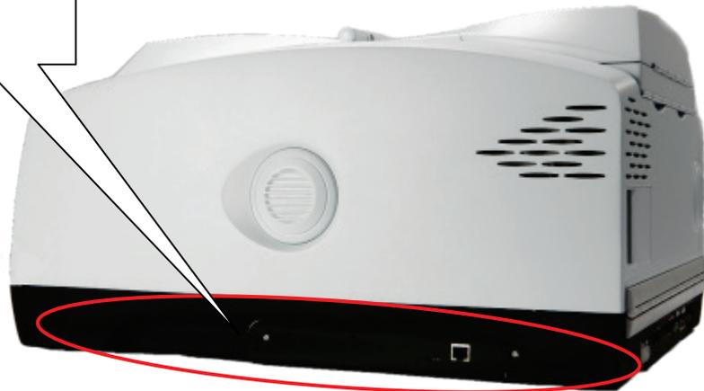
**Abb. 22. Tragegriffe am IR-Spektrometer Frontier**
