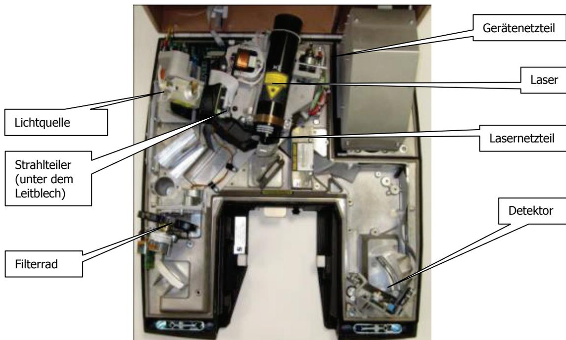
**Abb. 39. Hauptkomponenten des IR-Einbereichsspektrometers Frontier**
