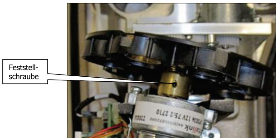
**Abb. 49. Filtrerrad mit Feststellschraube**
