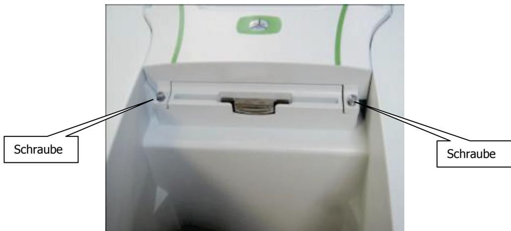
**Abb. 26. Unverlierbare Schrauben an der Abdeckung des Trockenmittelfachs**
