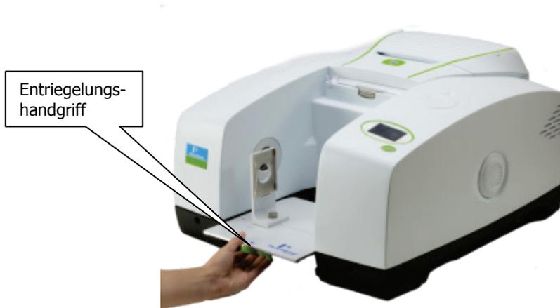
**Abb. 59. Entnehmen eines Messzubehörs**
