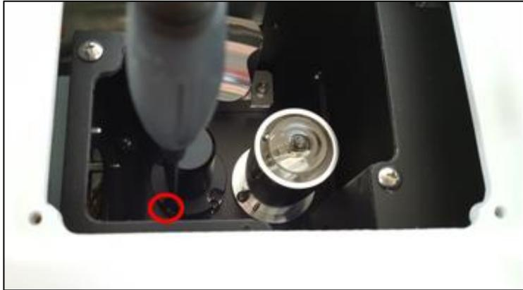
6. Lösen Sie die zwei Schrauben auf dem Modul der Wolfram-Lampe mit einem Phillips-Schraubendreher.
