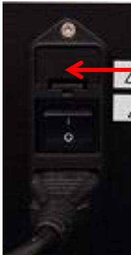
Die Verriegelung befindet sich an der Tür des Sicherungsfachs.
