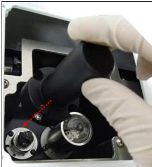
5. Befestigen Sie die Kopfschraube an dem Werkzeug für den Wechsel der Wolfram-Lampe, um das Werkzeug an dem Modul der Wolfram-Lampe zu befestigen.
