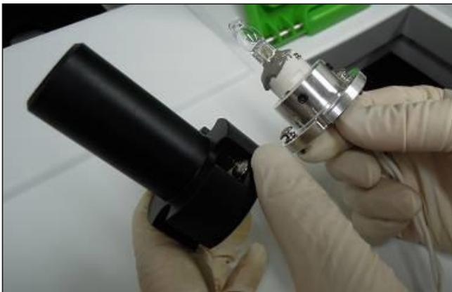
9. Ersetzen Sie die Wolfram-Lampe durch eine neue Lampe und bauen Sie die Teile in umgekehrter Reihenfolge wieder zusammen.
