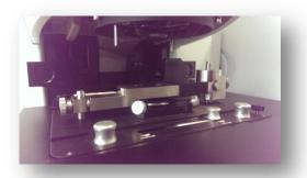
Probentischsteuerung: Scan – ATR-Untergrund aufnehmen
