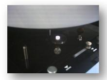
Nach der Probenplatzierung wird auf die Kristallmarkierung fokussiert, um zu gewährleisten, dass sich die Probe optimal im Fokus des ATR-Kristalls befindet, wie im visuellen Bild definiert.
