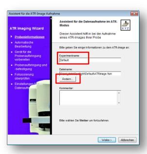
Für die Imageaufnahme können Parameter für eine automatische Spektrenbearbeitung ausgewählt werden
