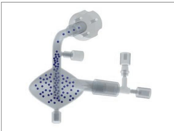
Das AMS-System des NexION minimiert den Verdünnungsbedarf vor der Analyse.
