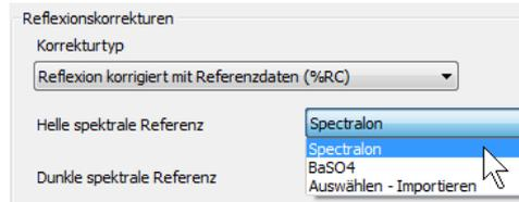
Verwenden Sie z.B. eine **Integrationskugel** („Ulbrichtkugel“) zur Messung der Reflexion, so wird für die Basislinie ein Spectralon-Standard verwendet. Eine unkorrigierte Messung ergibt dann 100%, wenn die Probe so gut wie der Standard reflektiert. Um die echte Reflexion zu erhalten, muss also noch mit den bekannten Werten des Standards korrigiert werden. Für Spectralon sind typische Werte standardmäßig mitinstalliert.
