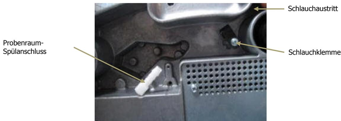
**Abb. 85. Spülgasanschluss des Probenraums**
