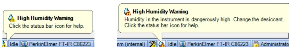
**Abb. 72. Warnmeldungen des Feuchtigkeitssensors bei hoher und bei kritischer Feuchtigkeit**
