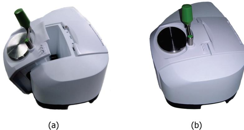
**Abb. 26. Installieren des UATR-Zubehörs**
