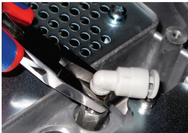
**Abb. 88. Einschrauben des rechtwinkligen Verbinders**
