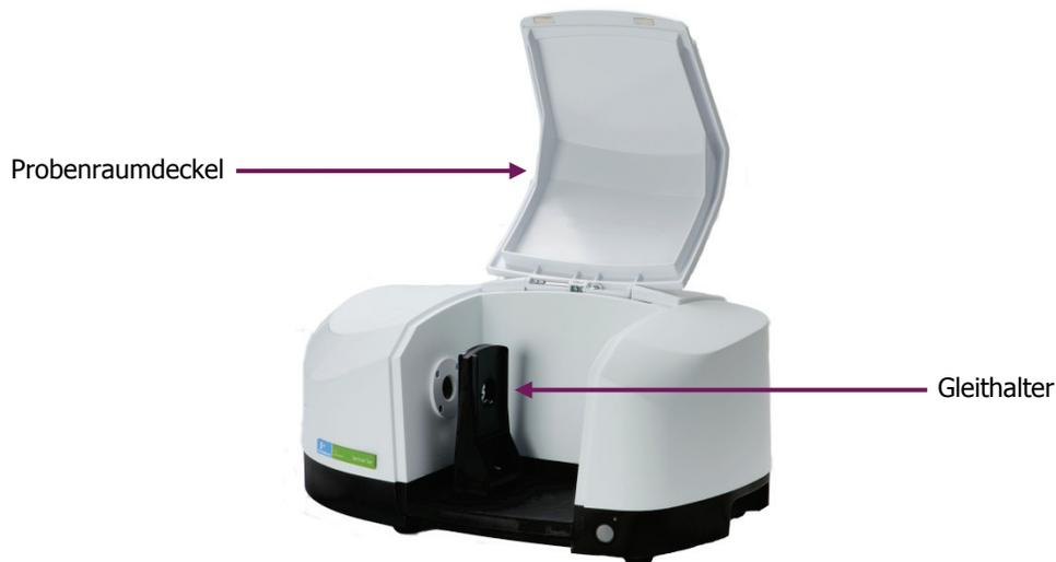
Abb. 4. Probenraum des Spectrum Two
