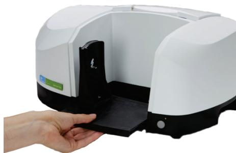
**Abb. 25. Entfernen des Messzubehörs**
