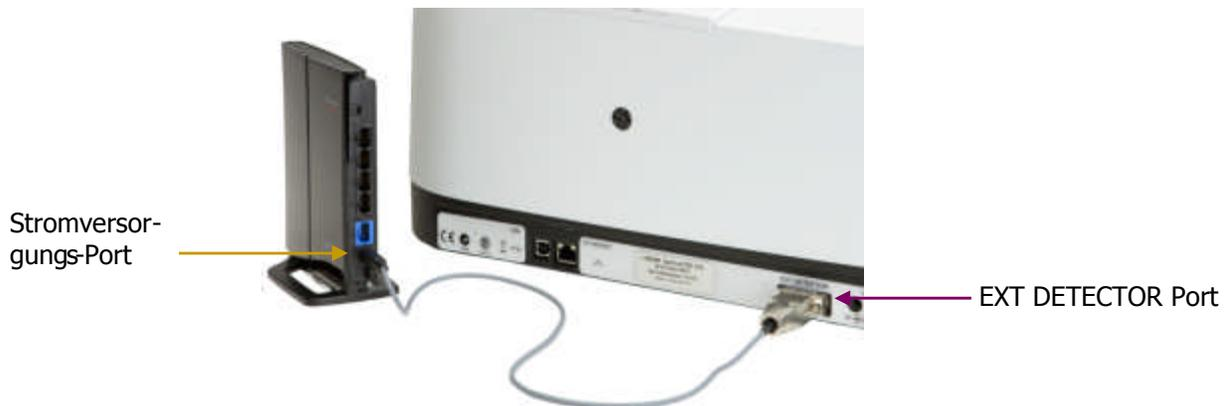
**Abb. 16. Wireless Router, angeschlossen am EXT DETECTOR Port**
