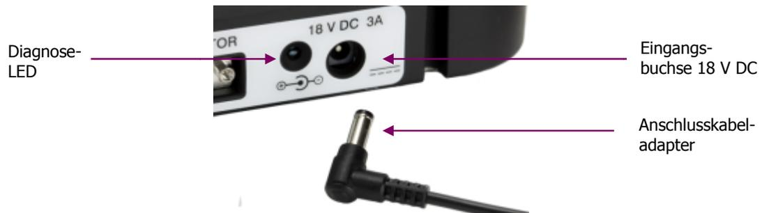
**Abb. 12. Eingangsbuchse für Gleichstrom an der Spektrometerrückseite**
